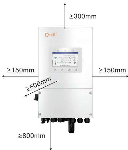
Figura 3.5 Distanze di montaggio dell'inverter
